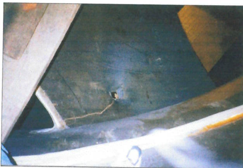
Figura 4.1: Trincas surgidas no rotor devido à operação em ressonância.
